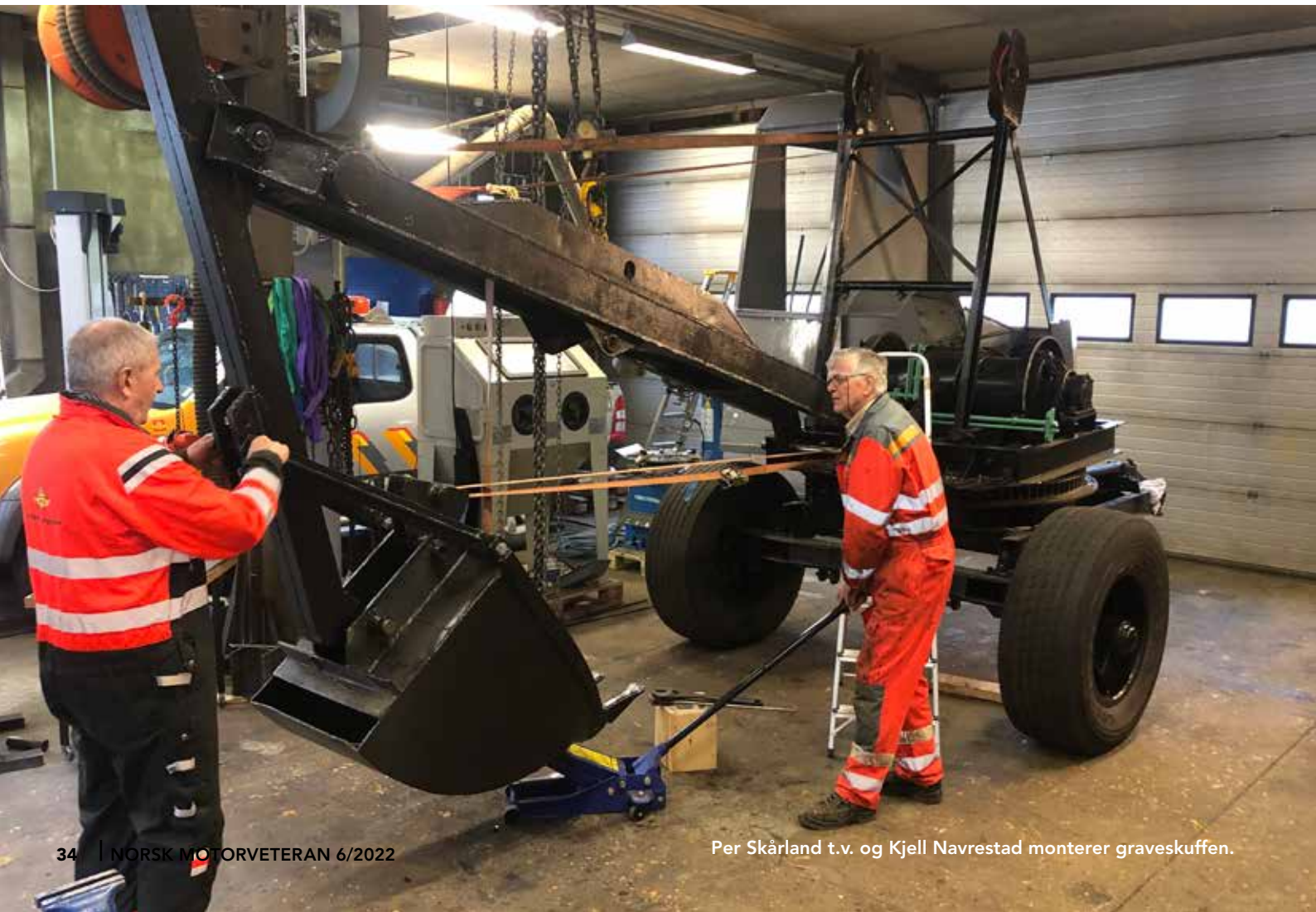
Rustne felger ble restaurert ved å sveise inn nye stykker der de var ødelagt.
