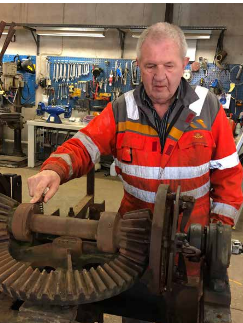
Per Skårland viser systemet for å svinge maskinen, to clutcher og støpte tannhjul for drift av svingfunksjonen.
