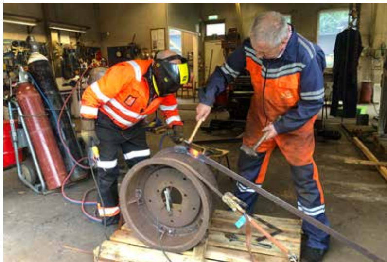
Rustne felger ble restaurert ved å sveise inn nye stykker der de var ødelagt.
